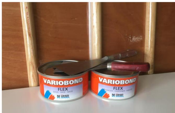
Beide Variobond-Komponenten sind mit hochwertigen Füllstoffen eingedickt. Dadurch behält Variobond auch bei der Durchhärtung seine Form und verflüssigt sich nicht.
