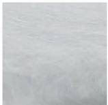
Dünnes Glasvlies mit in Styrol löslicher Bindung. Da sich der Binder sehr schnell im Harz auflöst, lassen sich auch komplizierte Geometrien und Krümmungen verarbeiten. Kompatibel mit NautiPox und NautiPol Harzen. Am besten für Polyester-Harze geeignet.
